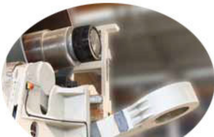
Abb. Halterung der Oberrolle hydraulisch abklappbar
